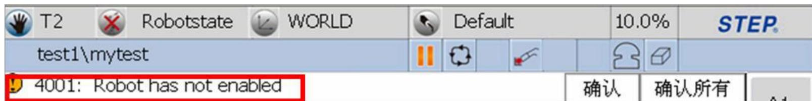
用于确认机器人系统内部报警信息，只有系统内部报警信息全部确认后，机器人才能再次上使能。如图所示：
